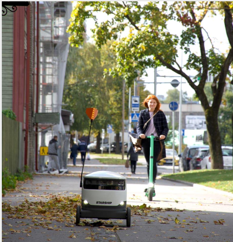
Starship navigerer frit i byrummet og holder tilbage for f.eks. fodgængere, cyklister, kørestole og hunde.
